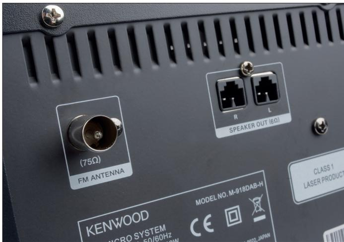
Die beiden zugehörigen Regallautsprecher werden per Steckverbindung an der Rückseite verbunden. Der 75-Ohm-Koaxanschluss ist für die mitgelieferte Wurf- oder eine eigene UKW/DAB-Antenne gedacht
